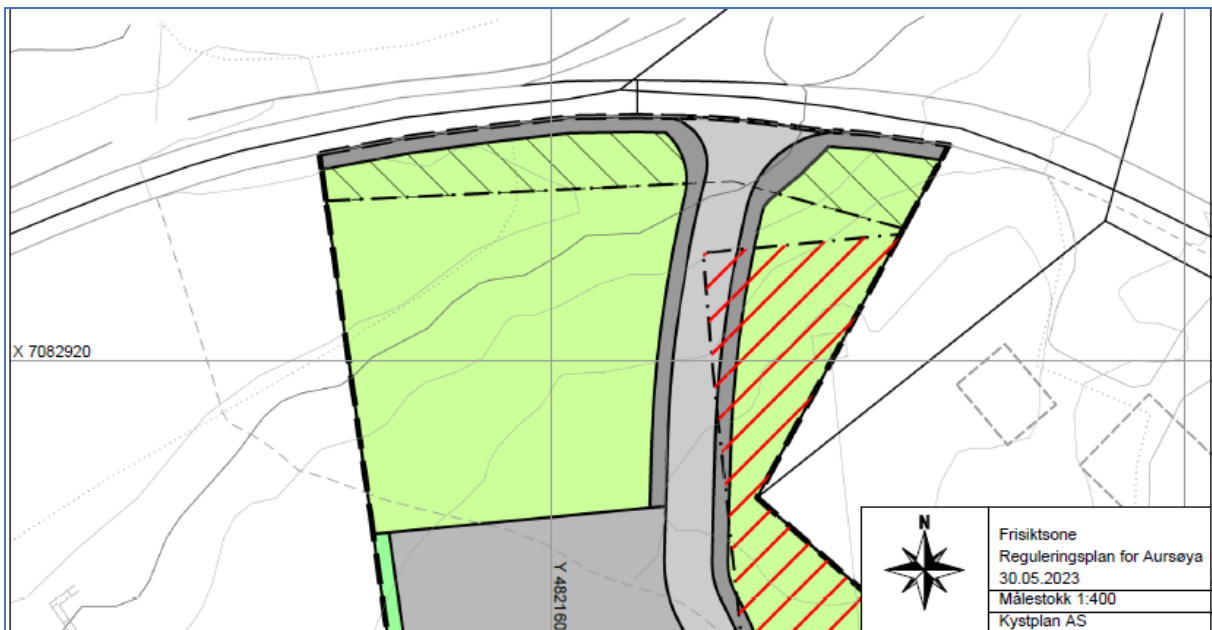
Figur 24: Frisiktsoner ved avkjørsel med inntegnet frisiktlinjer.
