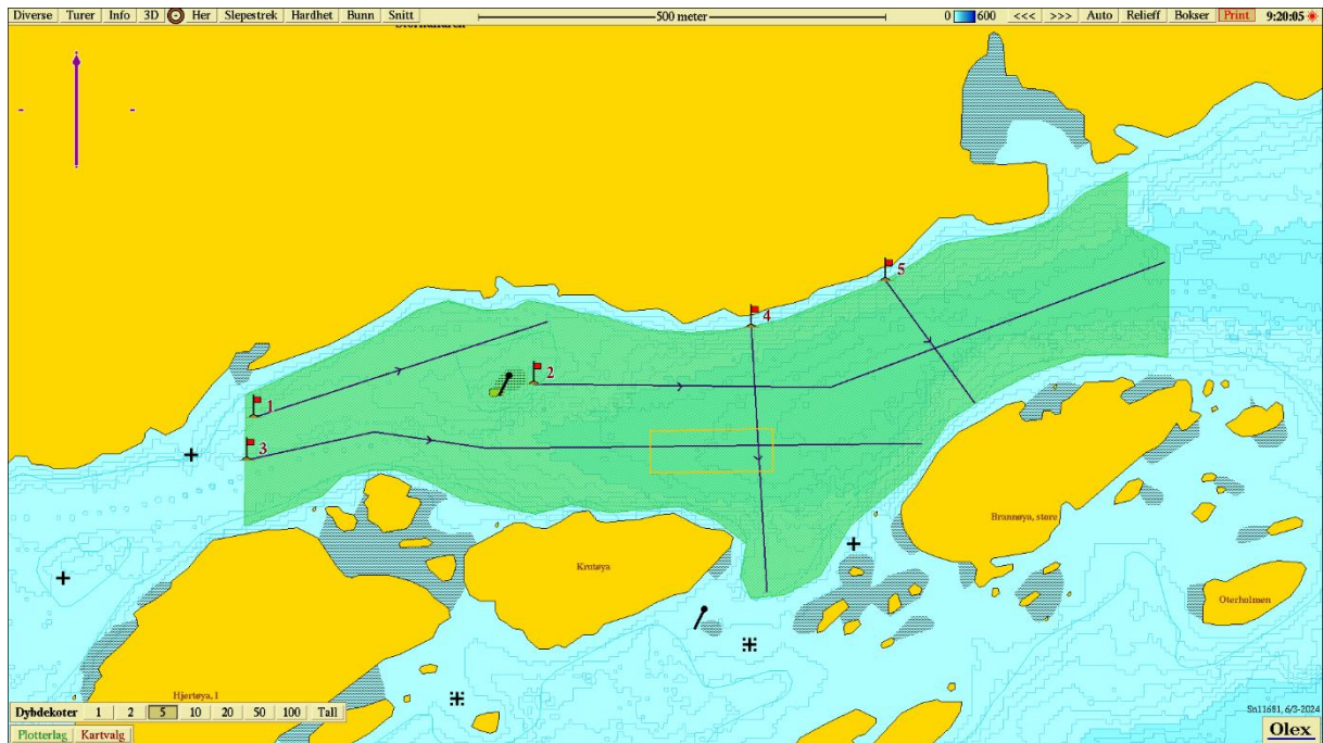
Figur 4: Oversiktskart over det planlagte kartleggingsarealet med anleggsrammen (Gul) og planlagte ROV kjørelinjer (Blå).
